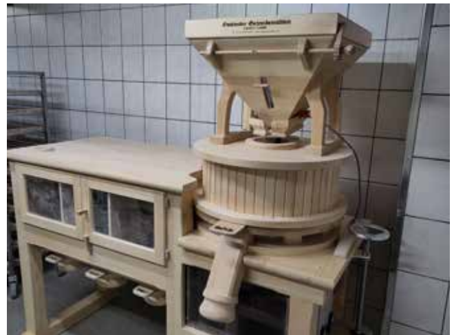
Eines der im Jahr 2025 geförderten Kleinprojekte: Getreidemühle mit Siebeinrichtung für eine Holzofenbäckerei
